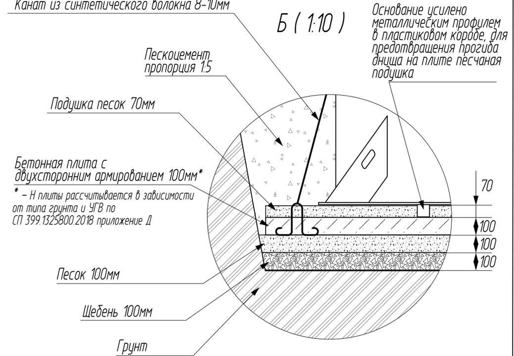
Бетонная плита с двухсторонним армированием 100мм\*
