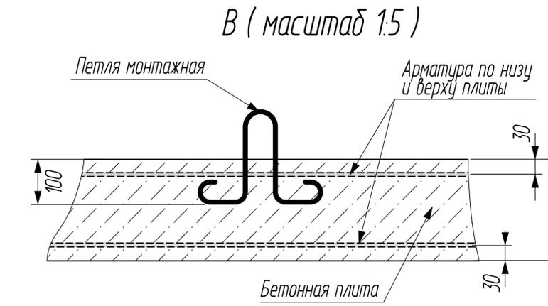
\* - H плиты рассчитывается в зависимости от типа грунта и УГВ по СП 399.1325800.2018 приложение Д
